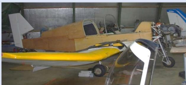
Le remarouflage consiste à retirer et à recoller, puis enduire la toile qui protège le contreplaqué du fuselage ou des bords d'attaque. L'ancien revêtement était craquelé et ne protégeait plus la cellule en bois contre l'humidité.
